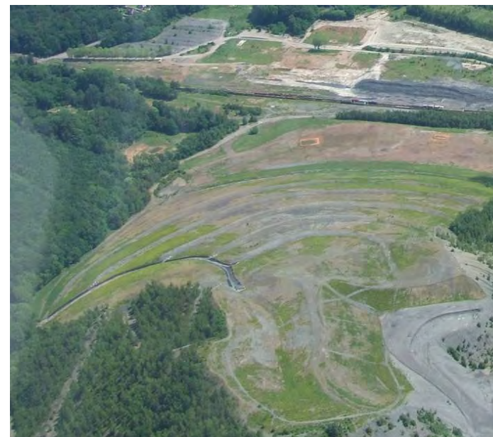
Les banquettes drainantes et la descente d'eau du terril La Houve 2
